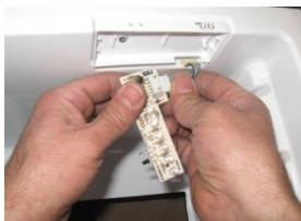
Retire la tarjeta LED y saque cuidadosamente el cable de datos.
