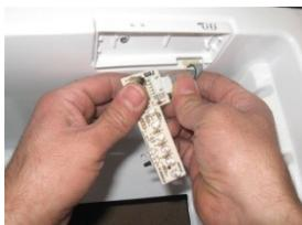
Ziehen Sie den LED-Steckplatine und Datakabel ab.
