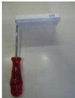
Retire la cubierta transparente con un destornillador plano.
